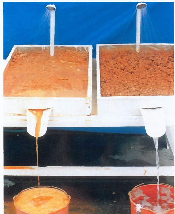
右がポリソイル団粒化土、左が無処理土。(国語マージ) 1時間 120mm 程度の降雨量にセットした。左の赤水に対し、右はまったくの清水。
